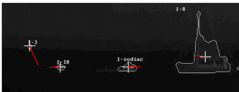
Figure 6 : détection de bateaux et analyse de vitesses (vecteur rouge). Image CEDIP. Le petit bateau numéroté I-3 a une vitesse élevée et se rapproche rapidement (trop ?) de nous.
