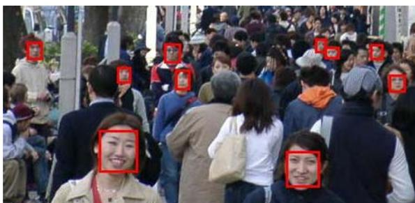
Figure 3 : détection de visages à la volée : les visages partiellement occultés (le haut du visage au centre) et ceux qui sont trop petits (en haut de l'image) ou de profil (à gauche) ne sont pas encore détectés par ces algorithmes.
